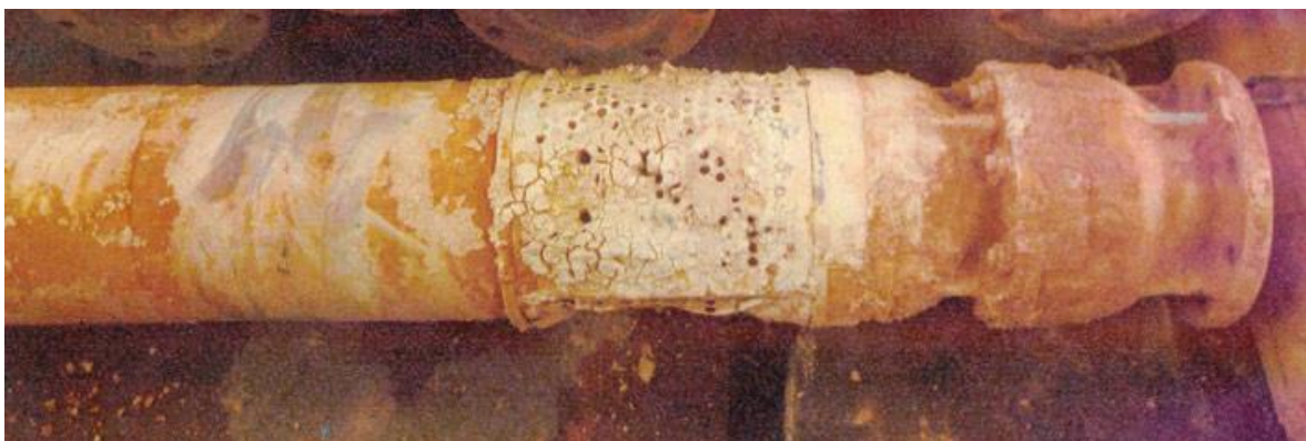
ЭЦВ ЗПН 10-120-60 после 8-месячной работы в скважине РВК-Воронеж в условиях повышенного содержания железа, ноябрь 2016
